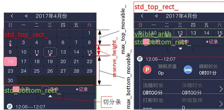
图 7-3 垂直模式的栈层控件
